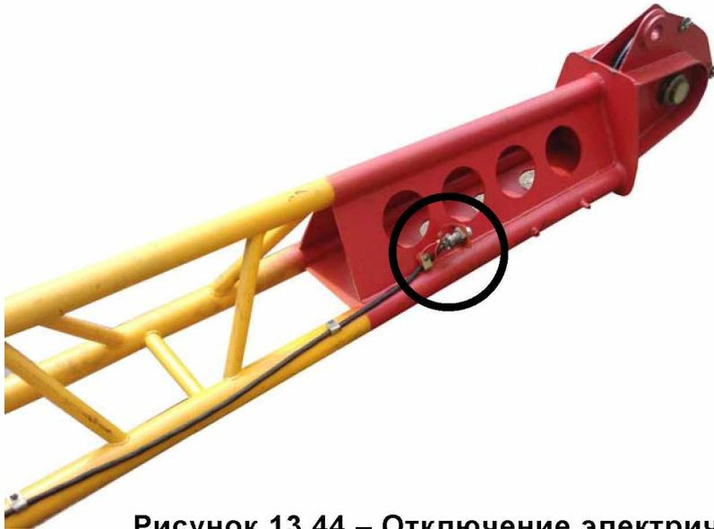
**Рисунок 13.44 – Отключение электрического кабеля на гуське**
