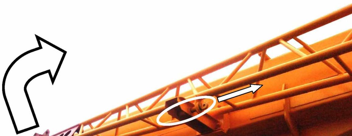
Рисунок 13.8 – Удаление пальца из кронштейна на стреле
