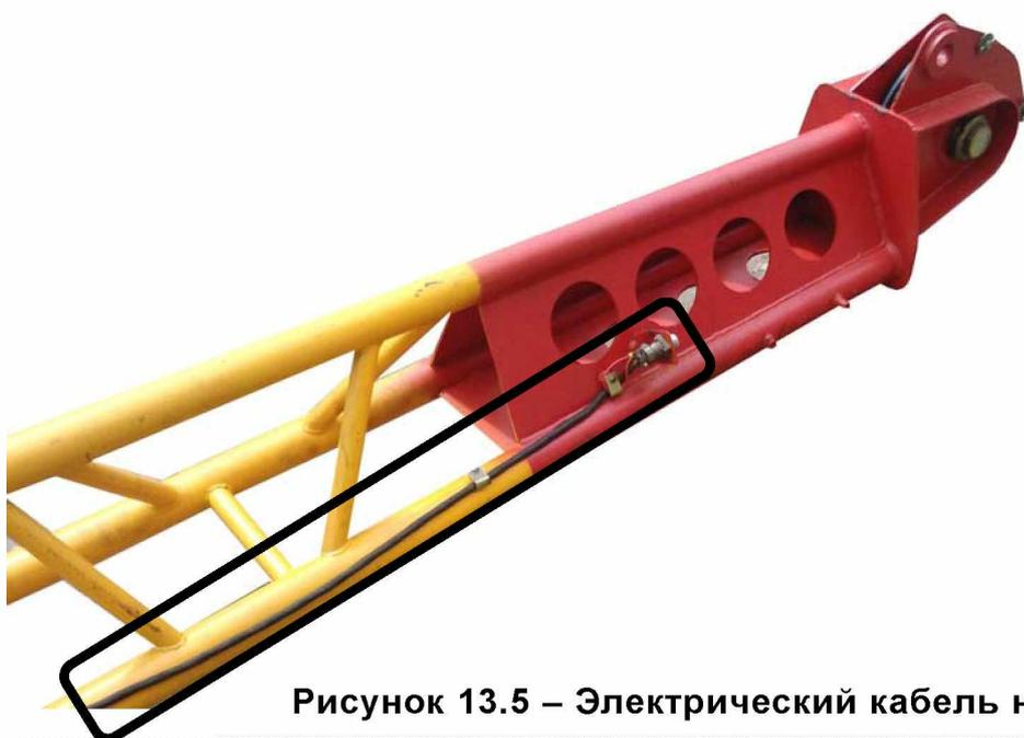
**Рисунок 13.5 – Электрический кабель на гуське**
