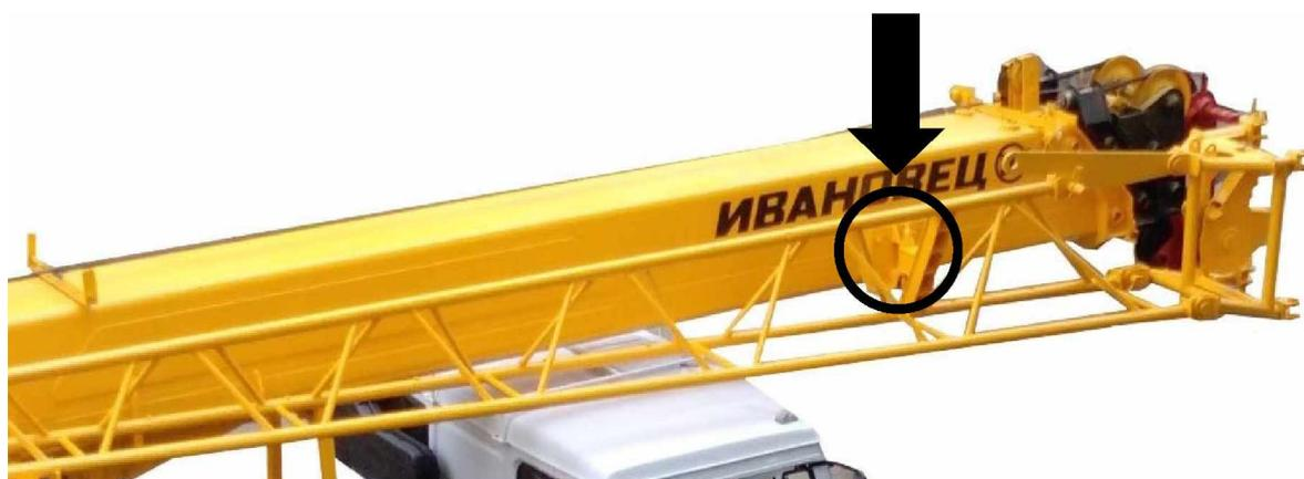
Рисунок 13.37 – Установка пальца в кронштейн на оголовке стрелы
