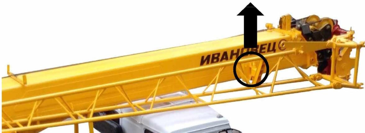
Рисунок 13.11 – Удаление пальца из кронштейна на оголовке стрелы
