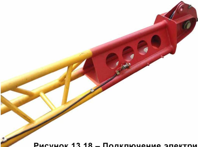
Рисунок 13.18 – Подключение электрического кабеля на гуське
