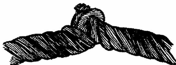
Рисунок Н.8 - Перекручивание каната
