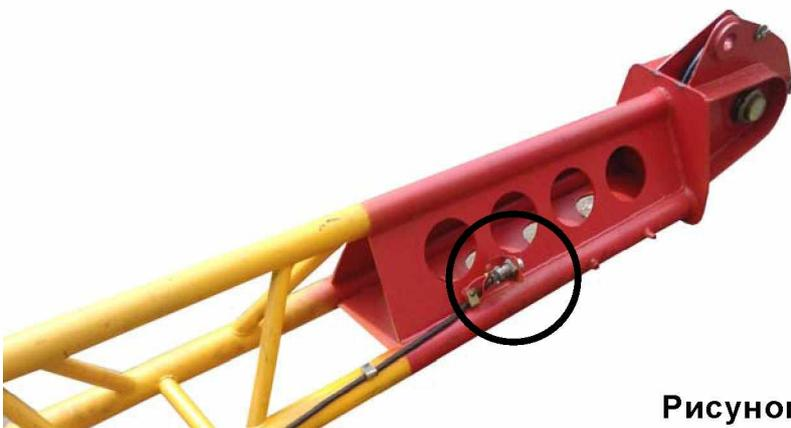
**Рисунок 13.17 – Подключение электрического кабеля на гуське**
