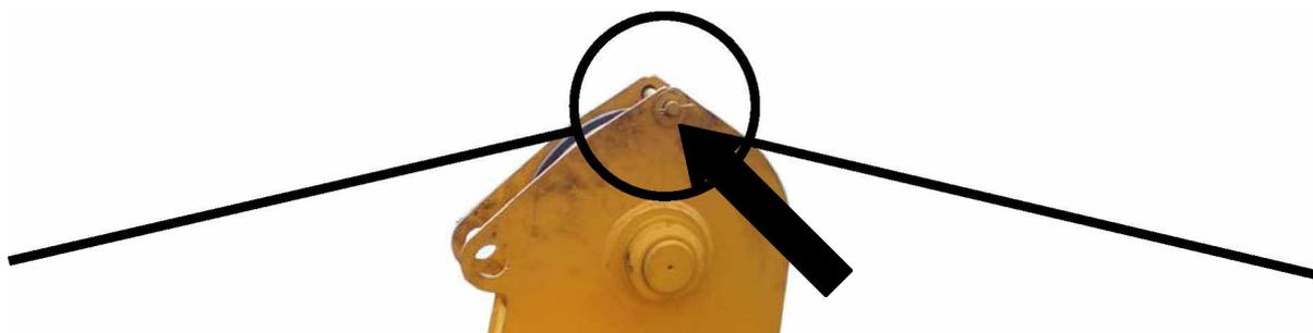
**Рисунок 13.31 – Установка оси на блоке основания гуська**
