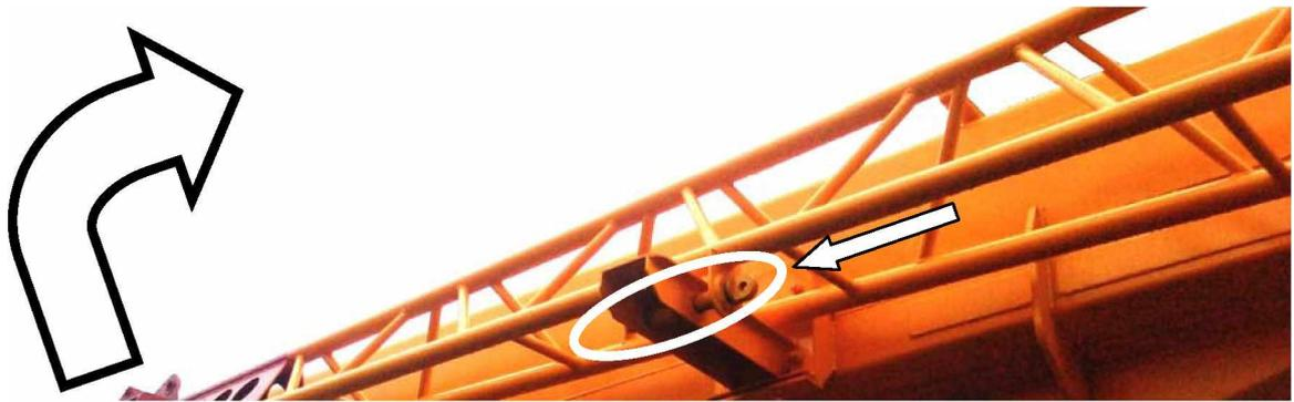
Рисунок 13.41 – Установка пальца в кронштейн на стреле
