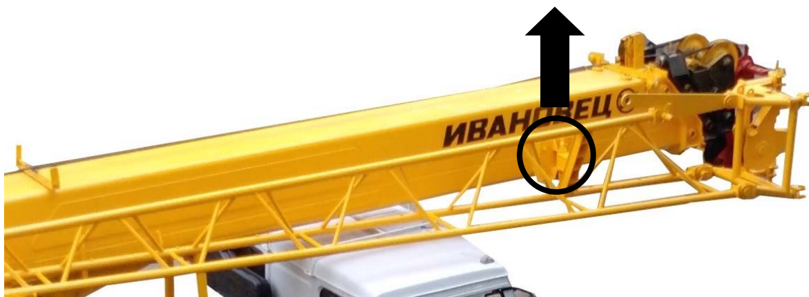
Рисунок 13.11 – Удаление пальца из кронштейна на оголовке стрелы
