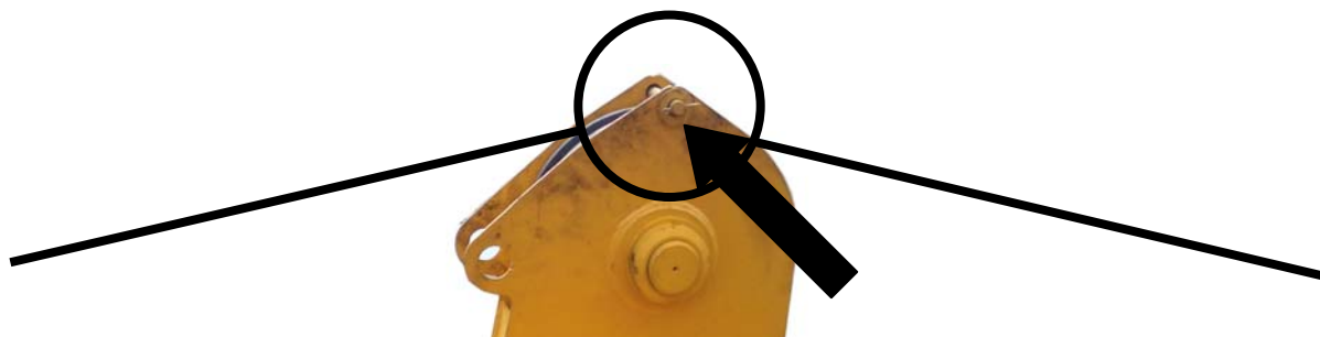
Рисунок 13.31 – Установка оси на блоке основания гуська
