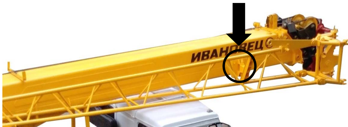
Рисунок 13.37 – Установка пальца в кронштейн на оголовке стрелы
