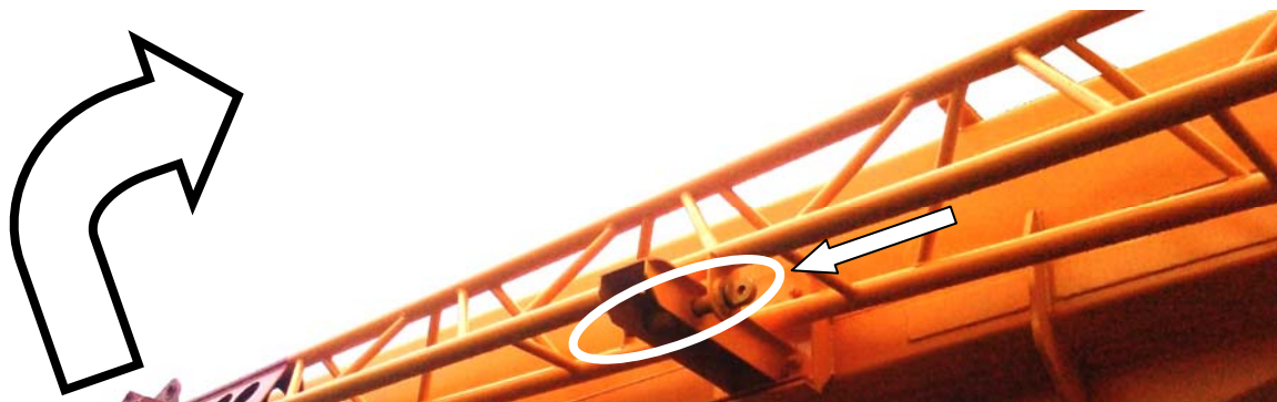
Рисунок 13.41 – Установка пальца в кронштейн на стреле
