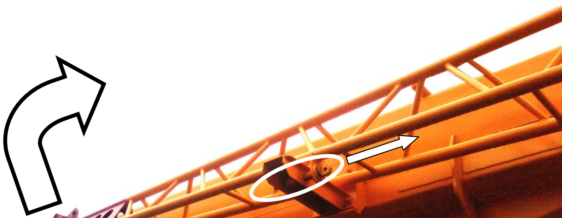
Рисунок 13.8 – Удаление пальца из кронштейна на стреле
