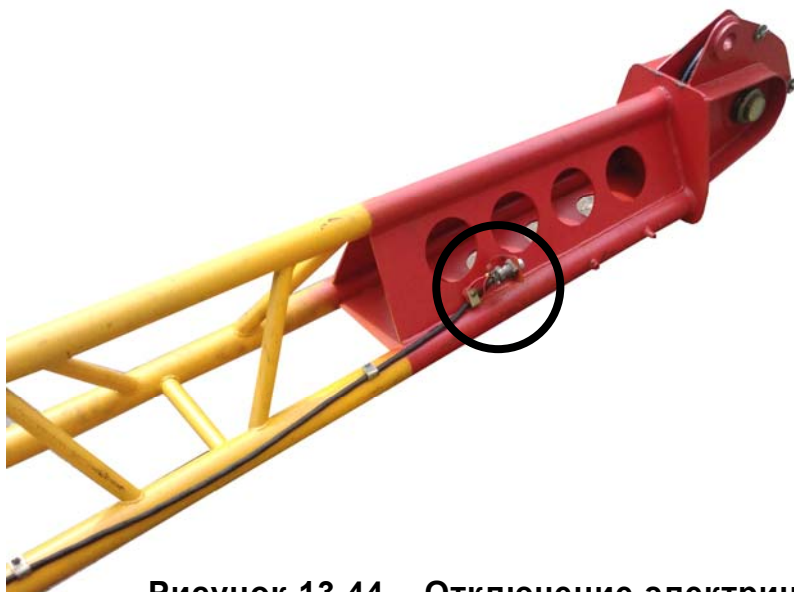
Рисунок 13.44 – Отключение электрического кабеля на гуське
