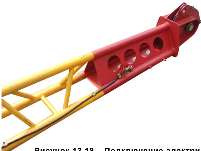
Рисунок 13.18 – Подключение электрического кабеля на гуське
