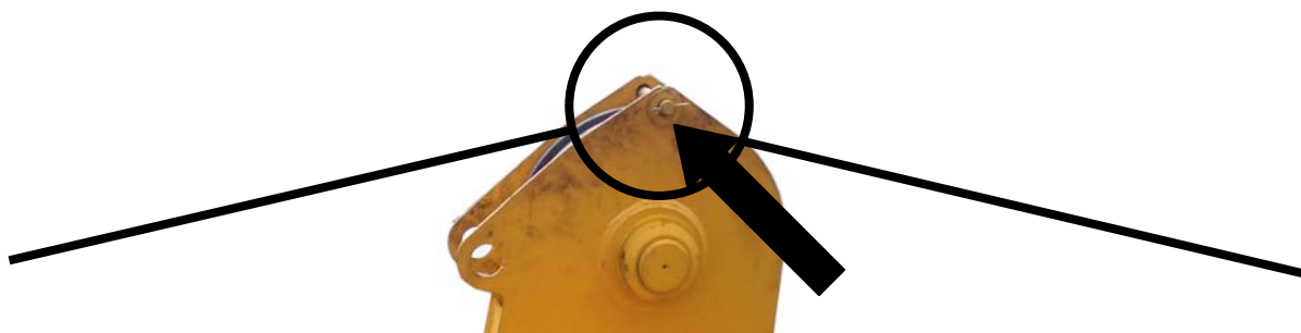
Рисунок 13.25 – Установка оси на блоке основания гуська
