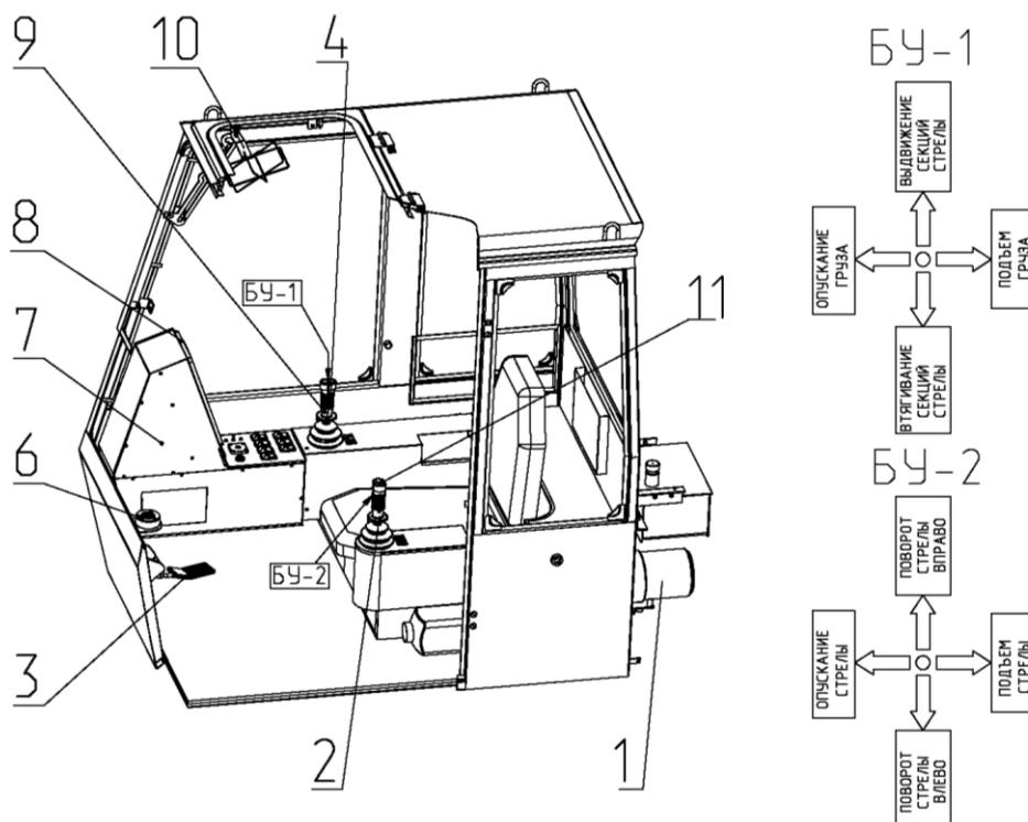
1 – отопительная установка (отопитель); 2- рычаг блока управления рабочими операциями подъема-опускания стрелы и поворота поворотной рамы вправо и влево; 3 - педаль управления топливоподачей; 4 - кнопка управления ускорением лебедки; 6- креномер; 7 - пульт управления; 8- блок отображения информации (БОИ ОНК); 9 - рычаг управления грузовой лебедкой и выдвиганием секций стрелы; 10 – вентилятор; 11 – кнопка «звуковой сигнал».
