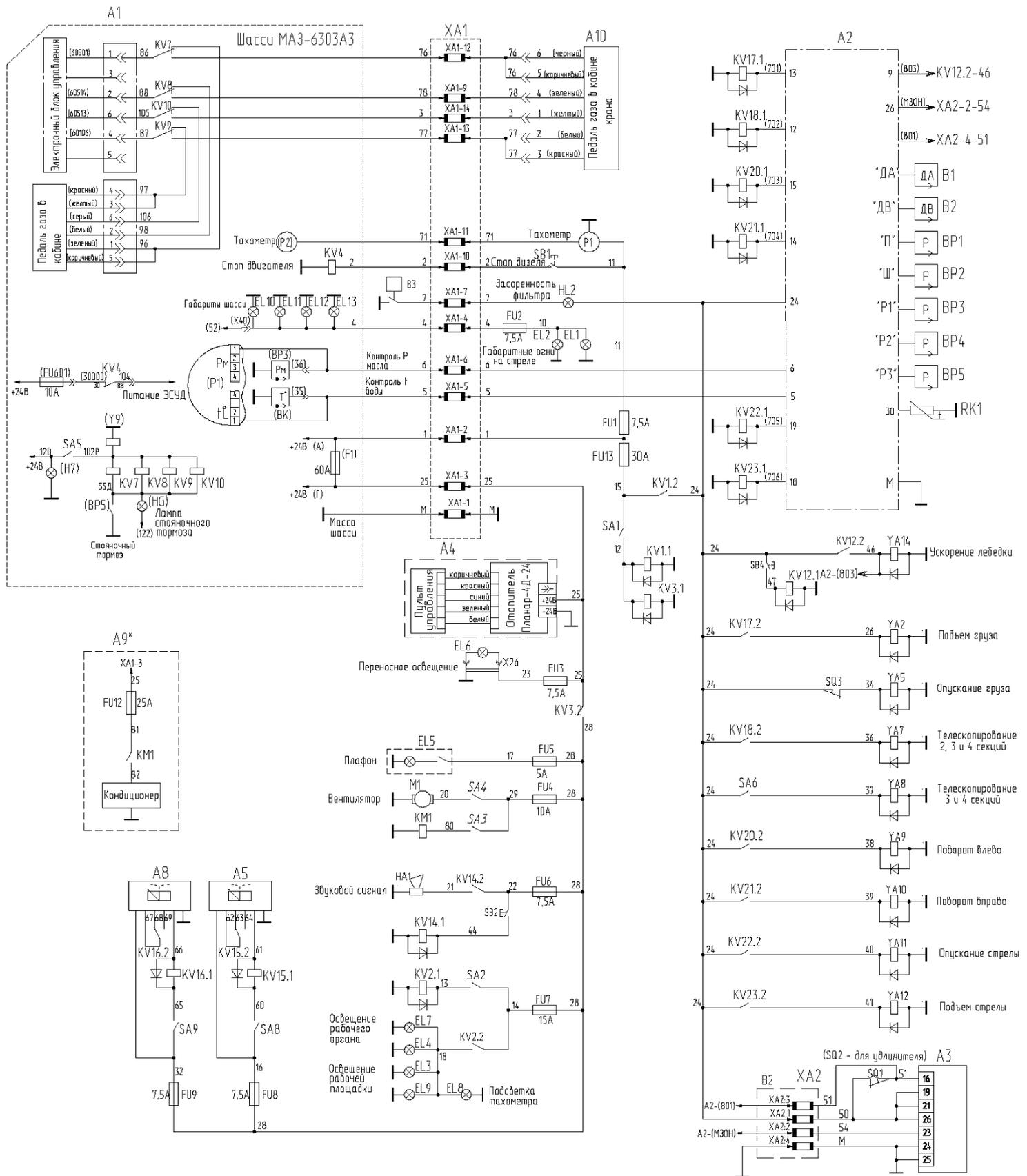
Рисунок 29 Схема электрическая принципиальная (шасси MAZ 6303A3)
