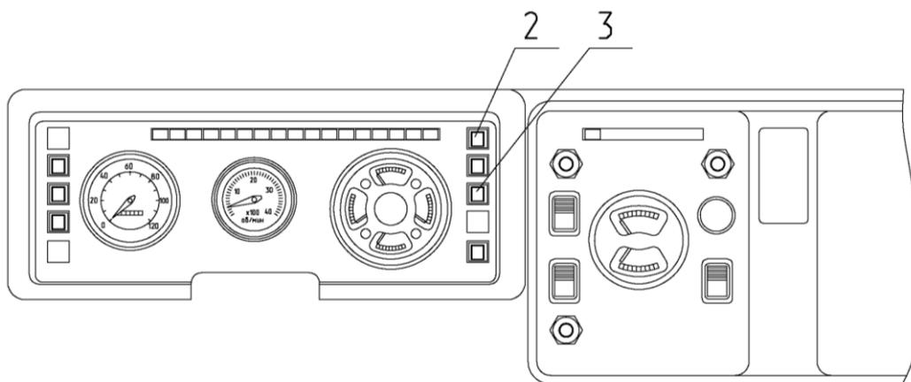
2 – включатель работы крана (включение КОМ); 3- включатель управления топливоподачей из кабины машиниста
