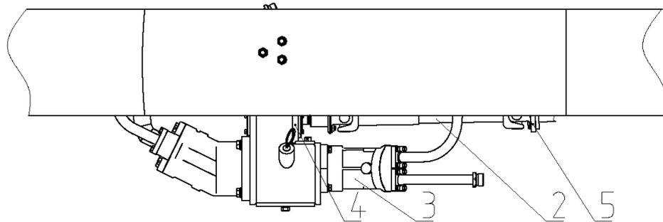
2 – карданный вал; 3 –редуктор привода насосов; 4 – кронштейн;
