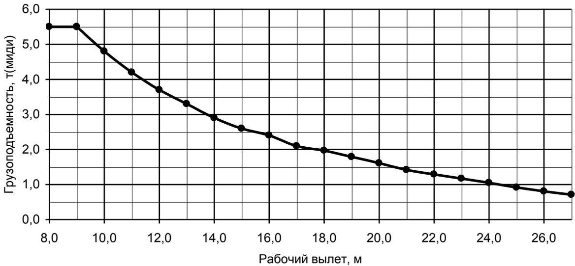
Грузовая характеристика. Лст=30,7м. κ=1. Установлен удлинитель, зона работы 240 град., противовес G=5,0 т
