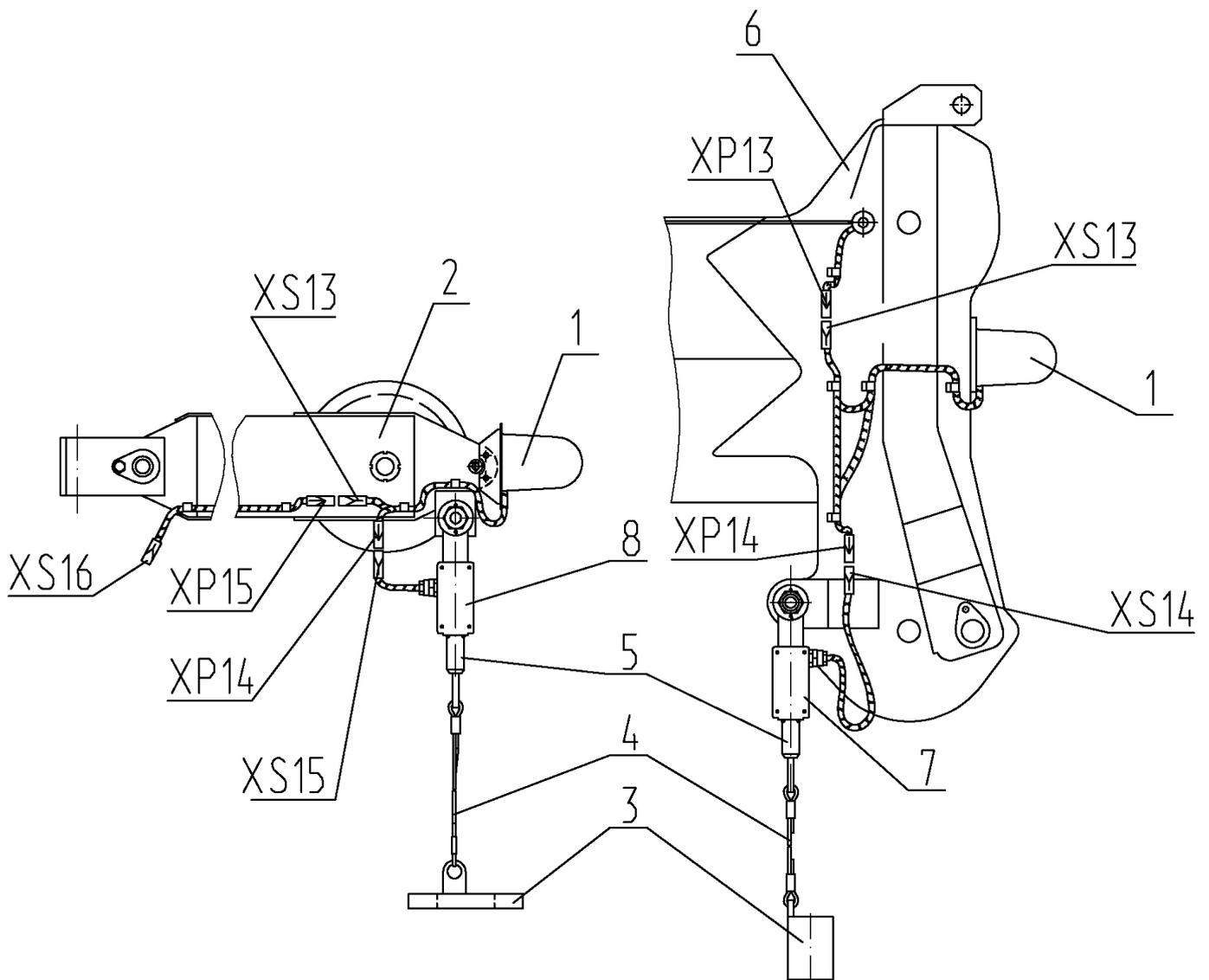
1 – контроллер оголовка стрелы (КОС); 2 – оголовок удлинителя; 3 – груза; 4 – тросики; 5 – выключатель; 6 – оголовок стрелы; 7 – ограничитель высоты подъема груза стрелы; 8 – ограничитель высоты подъема груза стрелы.
