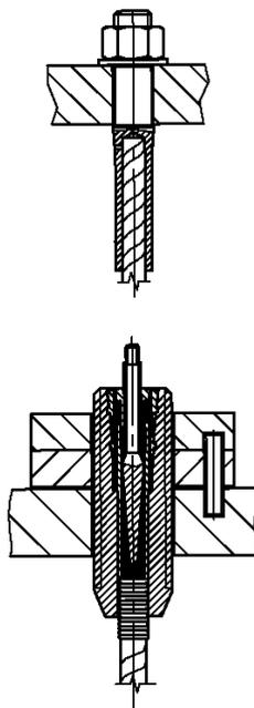
Рисунок Ж1 Схема запасовки канатов
