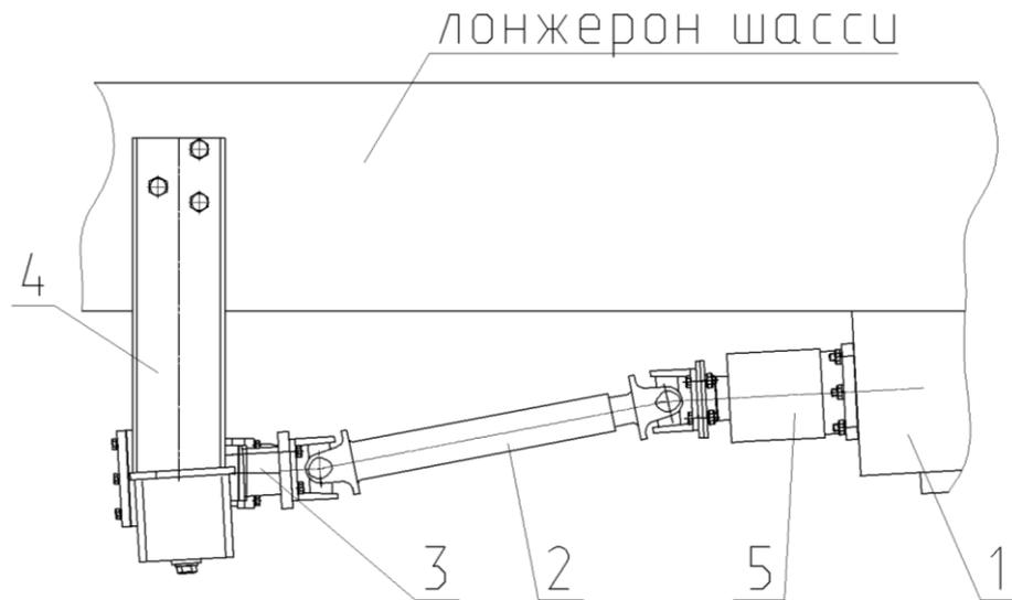
1 – коробка передач шасси; 2 – карданный вал; 3 –редуктор привода насосов; 4 – кронштейн;
