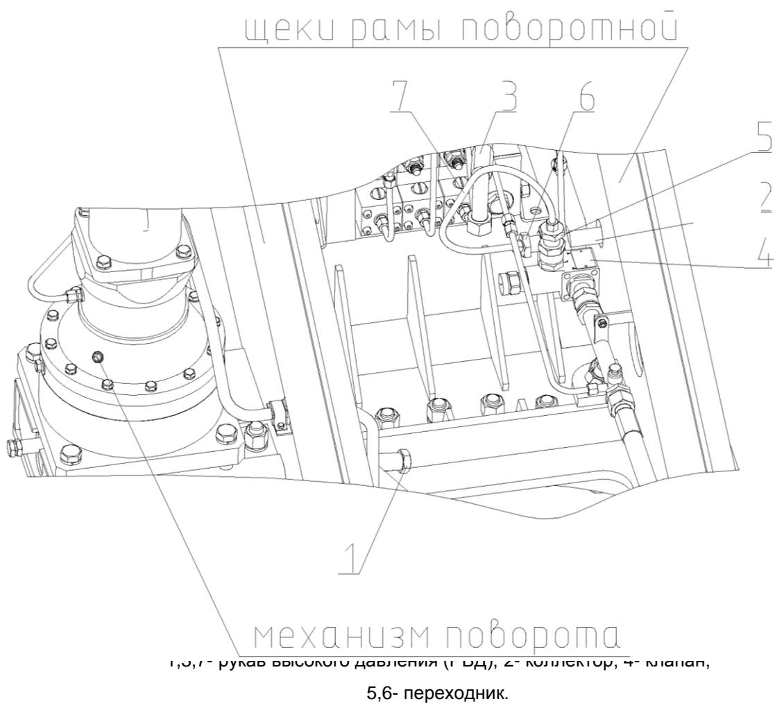
**Рисунок 64** Доработка гидравлической схемы при подъеме-опускании груза
