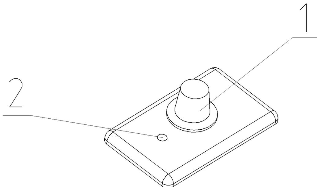
1- переключатель; 2- контрольная лампа «индикация состояния отопителя».
