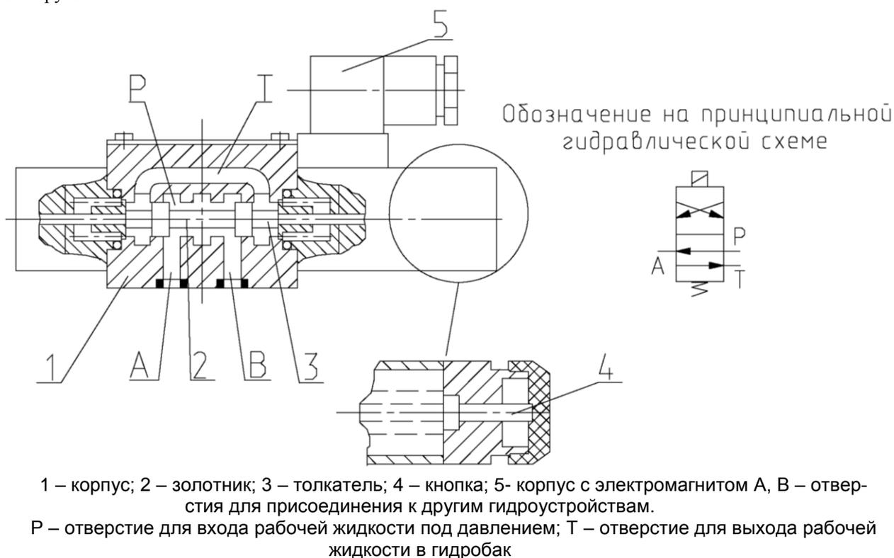
Рисунок 41 Гидрораспределитель с электроуправлением
