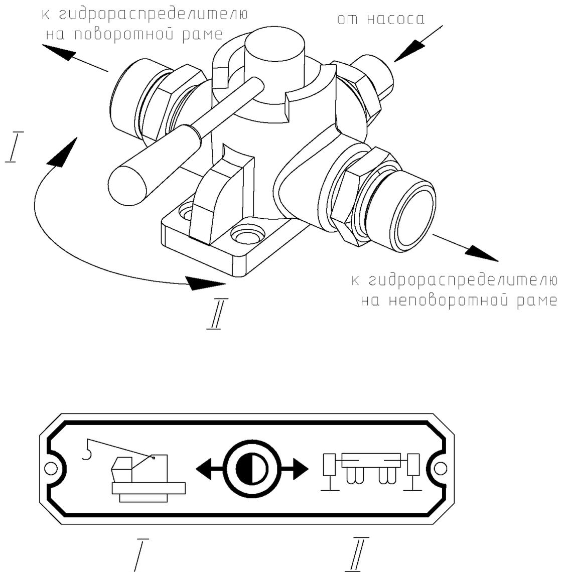
Рисунок 6 Управление двухходовым краном
