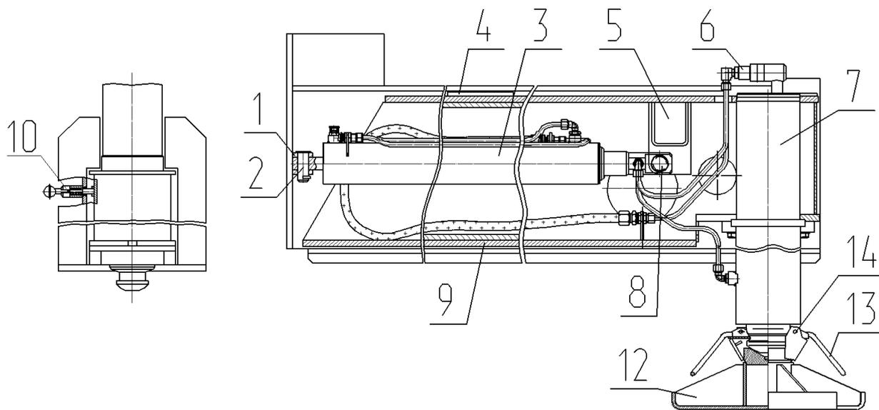
1,5 – кронштейны; 2,8 – ось; 3 – гидроцилиндр выдвижения; 4- ползун; 6 – гидрозамок; 7 - гидроцилиндр опорный; 9 – балка выдвижная; 10 – фиксатор; 11 – регулировочные прокладки; 12 – подпятник; 13 – ручки; 14 – ось ручки
