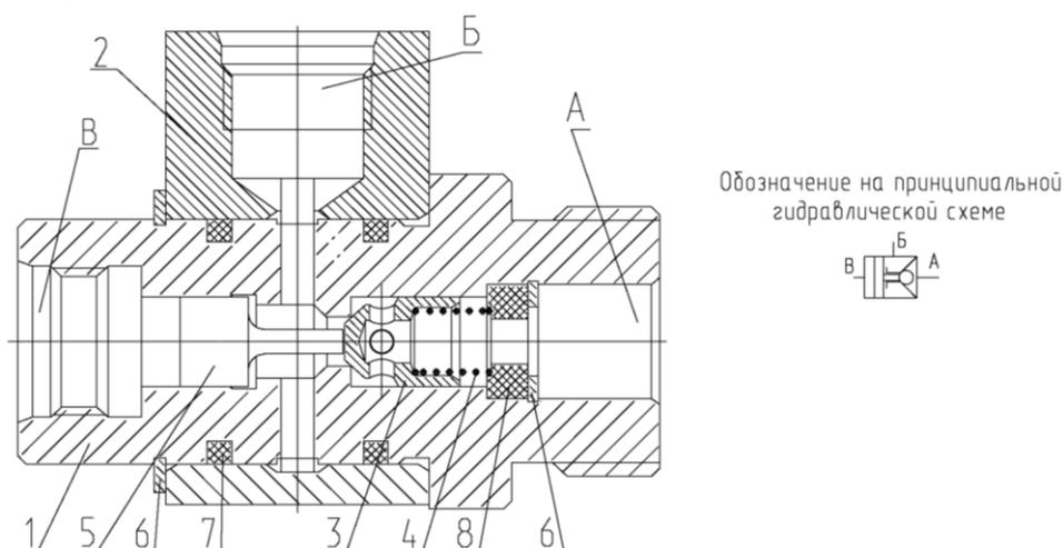
1 – корпус; 2 – угольник; 3 – обратный клапан; 4 – пружина; 5 – поршень –; 6 – кольцо стопорное; 7 – кольцо уплотнительное; 8 – шайба; А – к гидроцилиндру; Б – к гидрораспределителю; В - гидроуправление.
