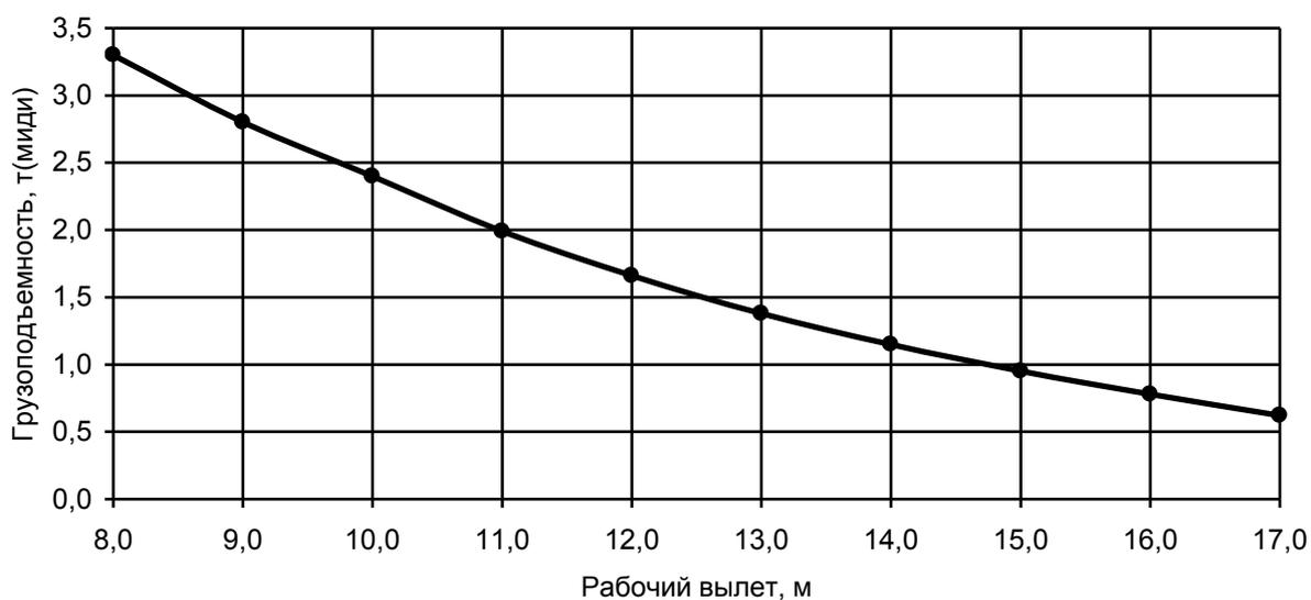
Грузовая характеристика. Лст=30,7м. κ=1. Установлен удлинитель, зона работы 360 град., противовес G=2,5 т
