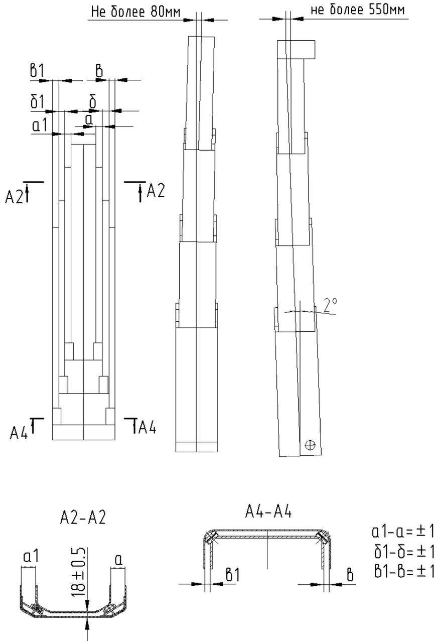
Рисунок 21.4 Схема регулировок отклонения секции от продольной оси
