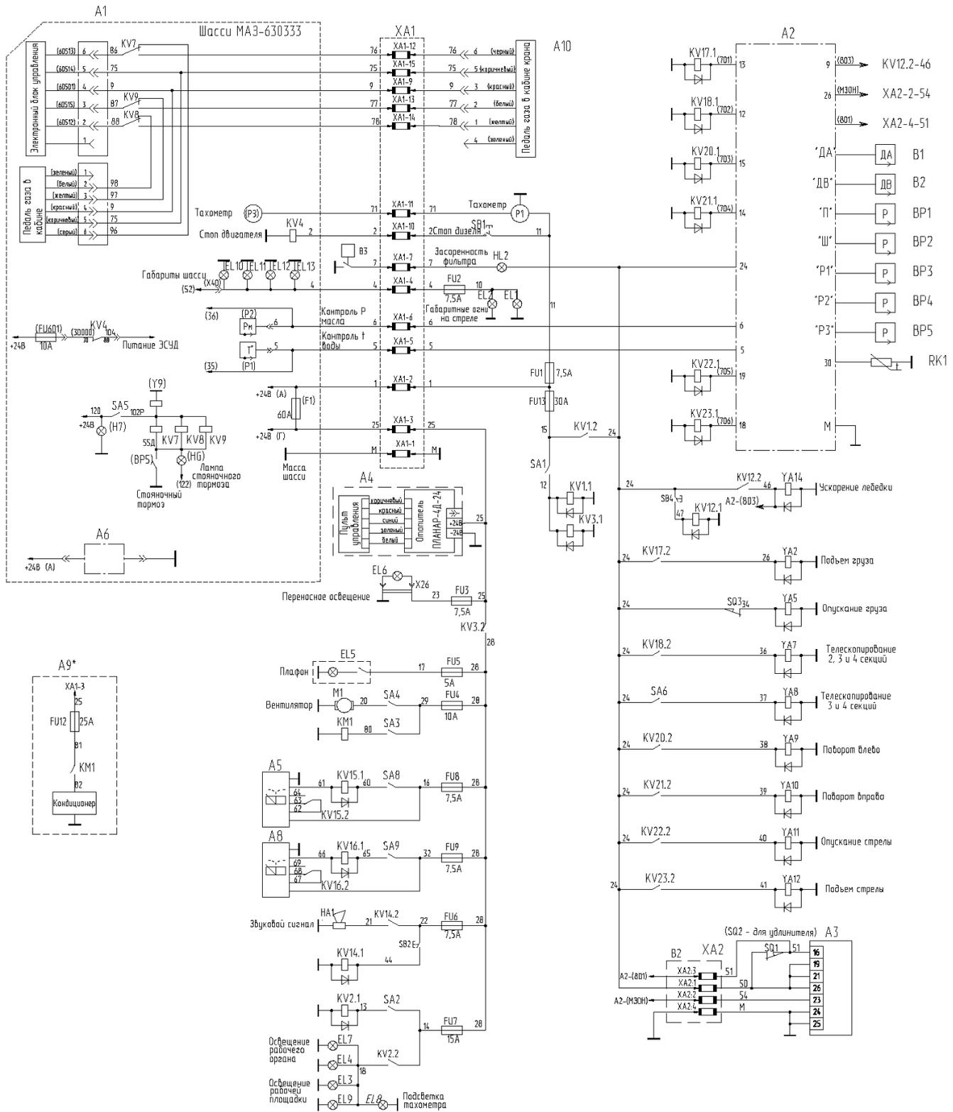
Рисунок 30 Схема электрическая принципиальная (шасси МА3 630333)
