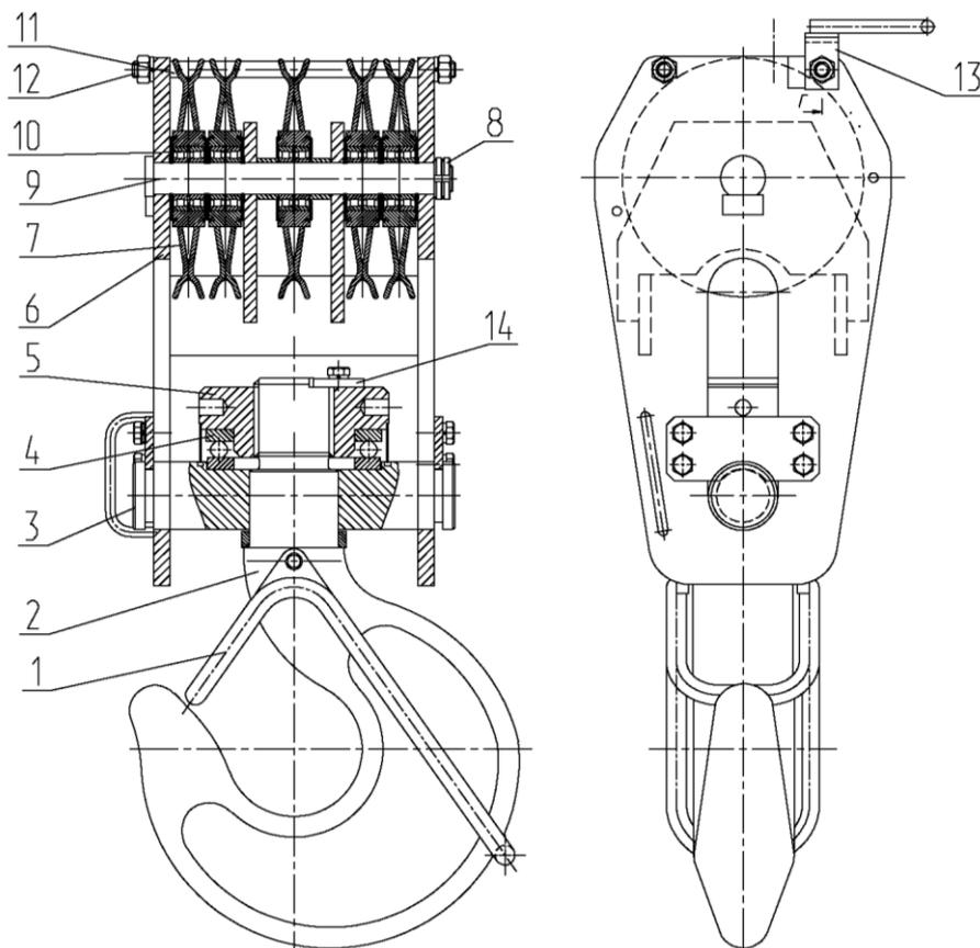
1 – скоба; 2 – крюк; 3 – траверса; 4, 10 – подшипники; 5 – гайка; 6 – щека; 7 – блок; 8 – гайка; 9 – ось; 11 – трубка распорная; 12 – шпилька; 13 – упор; 14 – планка.
