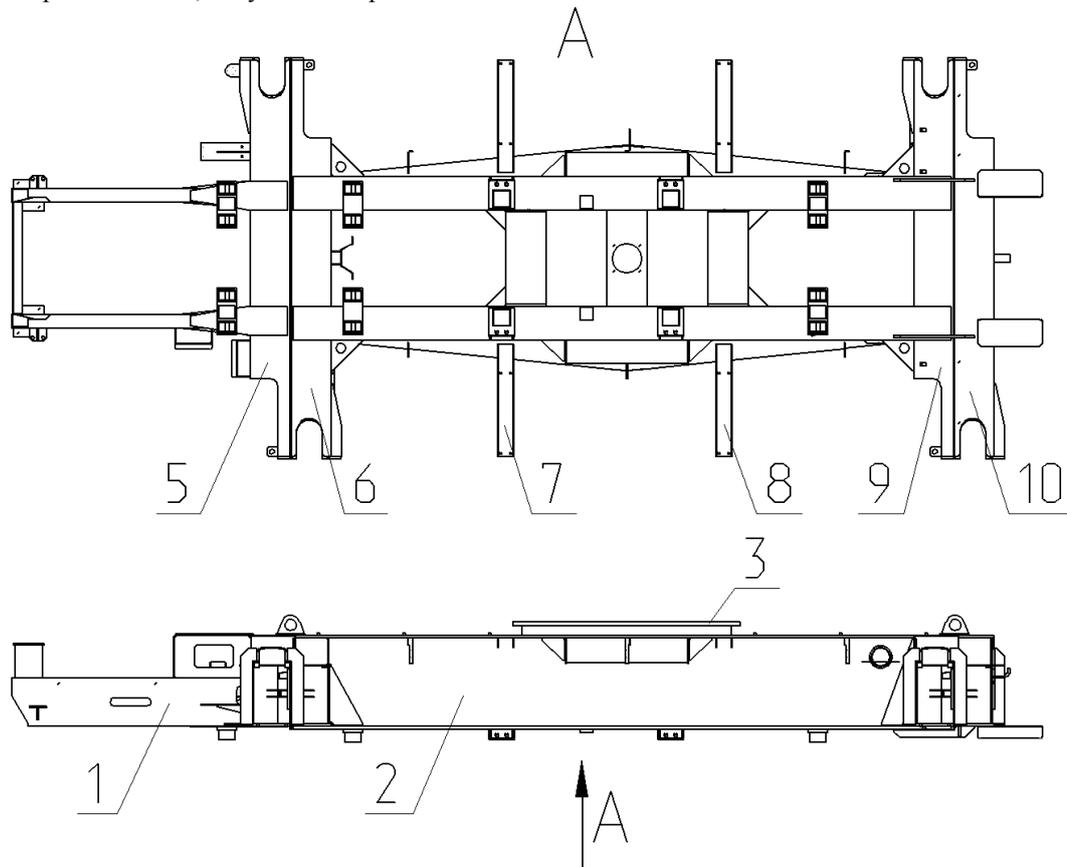
1 – надрамник; 2 – балка продольная; 3 – проставка; 5,6,9,10 – балки поперечные;
