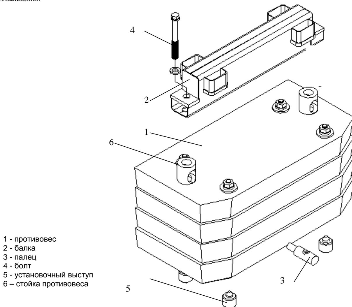
Рисунок 27 Установка дополнительного противовеса
