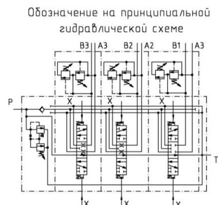
1 – напорная секция; 2,3,4 – рабочие секции; 5 – сливная секция; 6 – крепление; 7 – предохранительный клапан распределителя; 8 – предохранительные клапана механизмов; 9 – стяжные шпильки; A1, A2, A3, B1, B2, B3 – рабочие отводы; X – гидроуправление золотниками; P – напорный отвод; T – сливной отвод;
