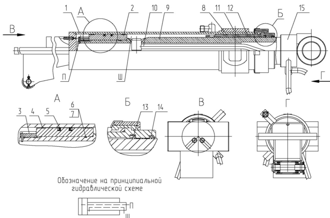
1 – гильза; 2 – поршень; 3 – гайка; 4 – кольцо направляющее; 5 – манжета; 6 – кольцо уплотняющее; 7 – втулка; 8 – кольцо направляющее; 9 – шток; 10 – трубопровод; 11 – цапфа гильзы; 12 – букса; 13 – кольцо уплотняющее; 14 – грязесъемник; 15 – цапфа штока; 16 – пробка
