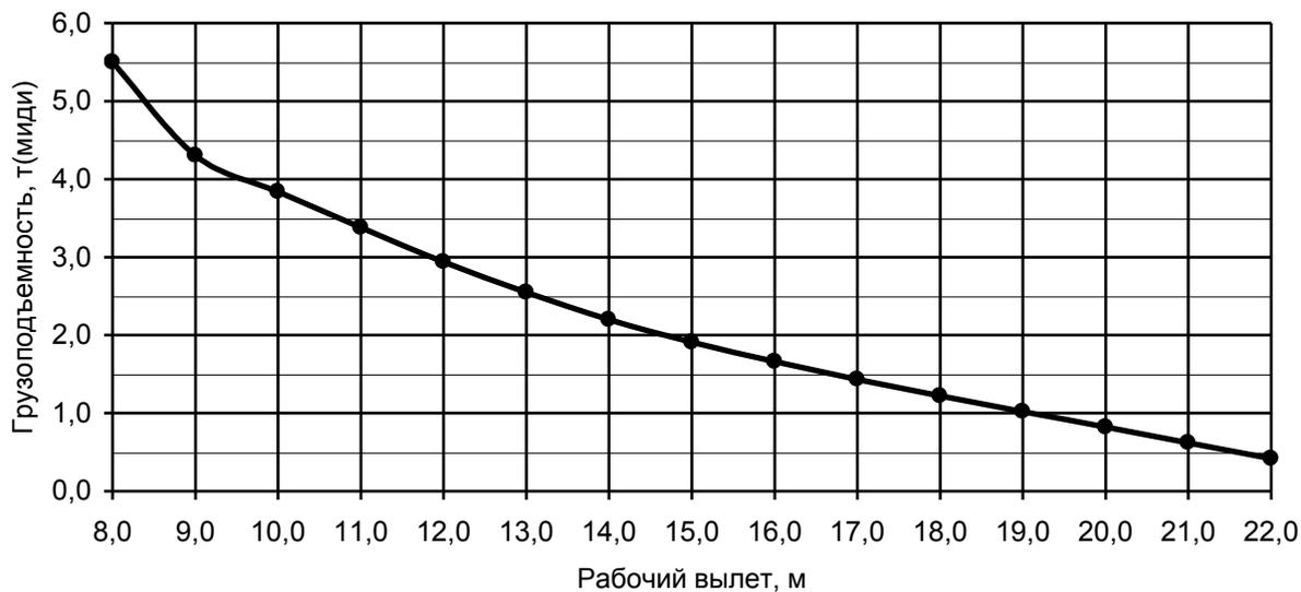
Грузовая характеристика. Лст=30,7м. κ=1. Установлен удлинитель, зона работы 240 град., противовес G=2,5 т.
