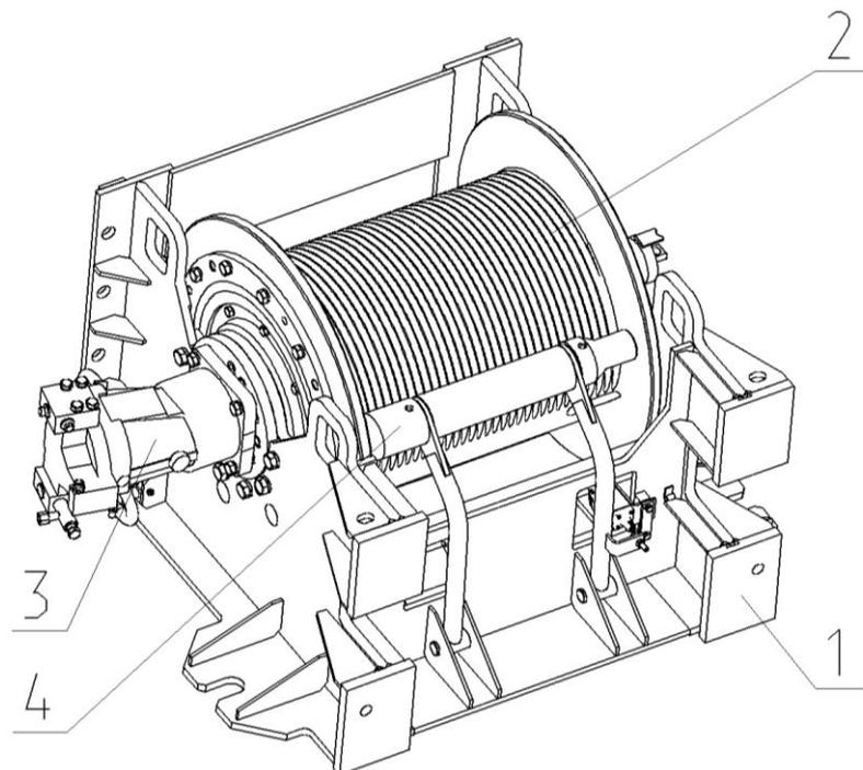
1 – рама; 2 – барабан; 3 – гидромотор; 4 – прижимной ролик
