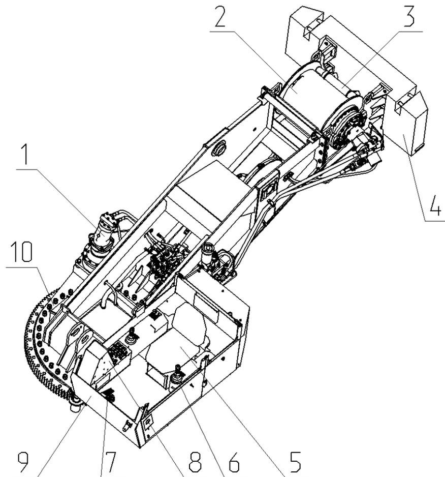
1 – механизм поворота; 2 – лебедка грузовая; 3 – ролик прижимной; 4 – противовес; 5 – кресло машиниста; 6 – рычаги управления крановыми операциями; 7 – педаль управления топливоподачей; 8 – пульт управления; 9 – кабина машиниста; 10 – рама поворотная
