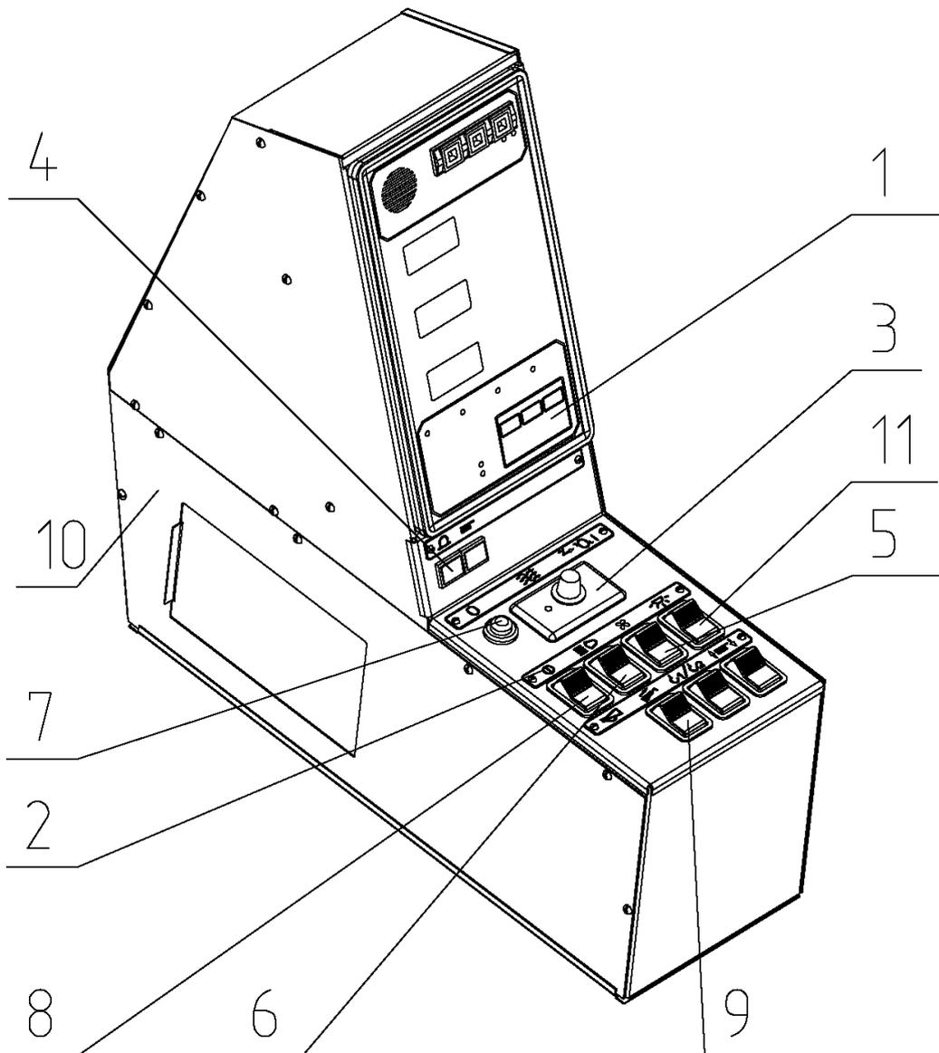
1 – блок отображения информации – БОИ (ОНК-160С); 2 – информационная табличка; 3 – пульт управления отопителем; 4 – контрольная лампа «засоренность масляного фильтра»; 5 – клавиша «включение вентилятора»; 6 – клавиша «включение фар»; 7 – кнопка «останов двигателя»; 8 – клавиша «включение крановой установки»; 9 – клавиша «выдвижение пакета»; 10 – корпус; 11 – клавиша «включение внутреннего освещения».
