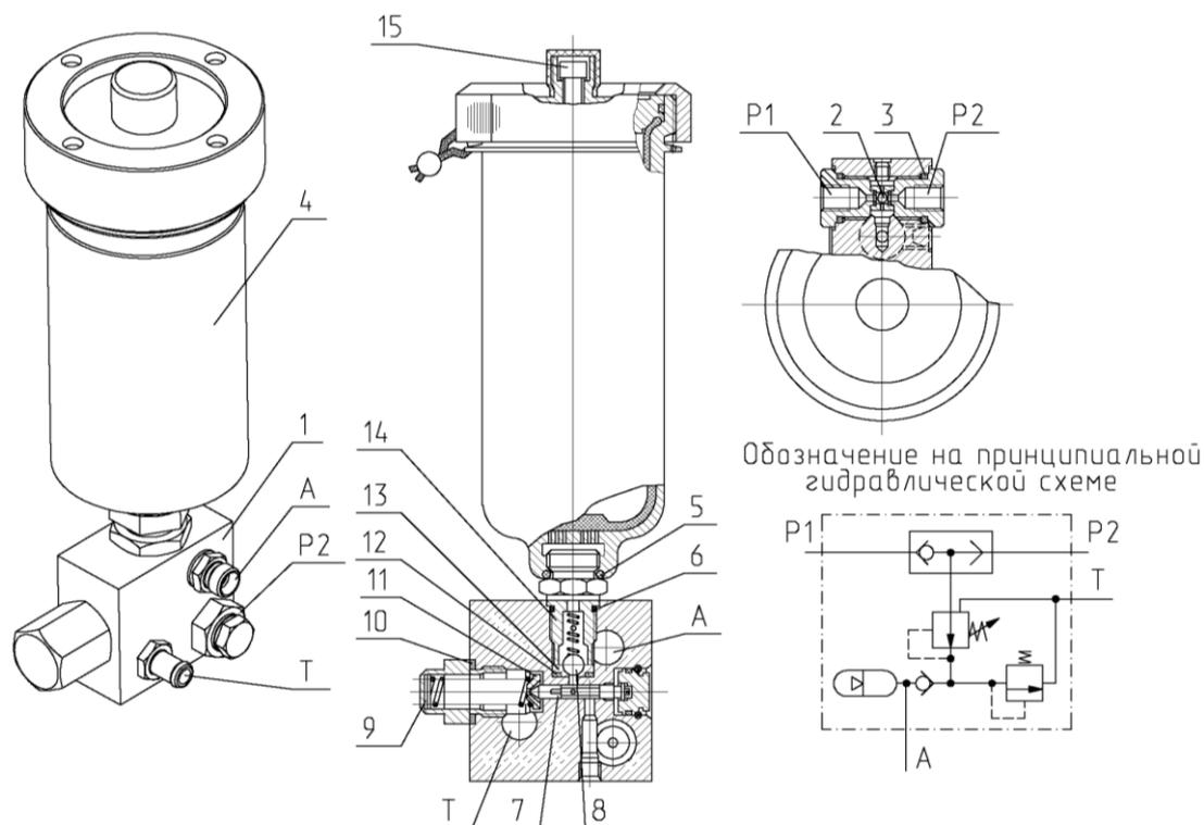
1-блок гидроклапанов; 2-клапан «или»; 3,5,6,10,12- уплотнительные кольца; 4- баллон; 7- ре-
