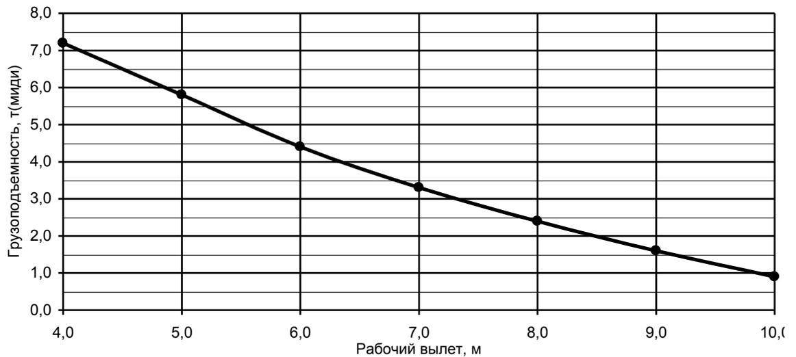
Грузовая характеристика. Лст=9,9м. к=10, зона работы 240 град. и 360 град. противовес G=5,0 т. опорный контур 4,1x2,3 м
