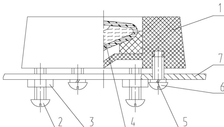
1 – корпус; 2,6 – винты; 3 – гайка; 4 – ампула;
