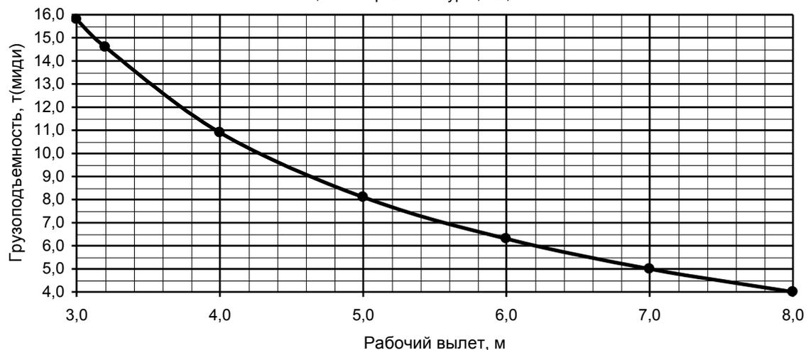
Грузовая характеристика. Лст=11,0м. к=10, зона работы 240 град. и 360 град. противовес G=5,0 т. опорный контур 4,1x2,3 м
