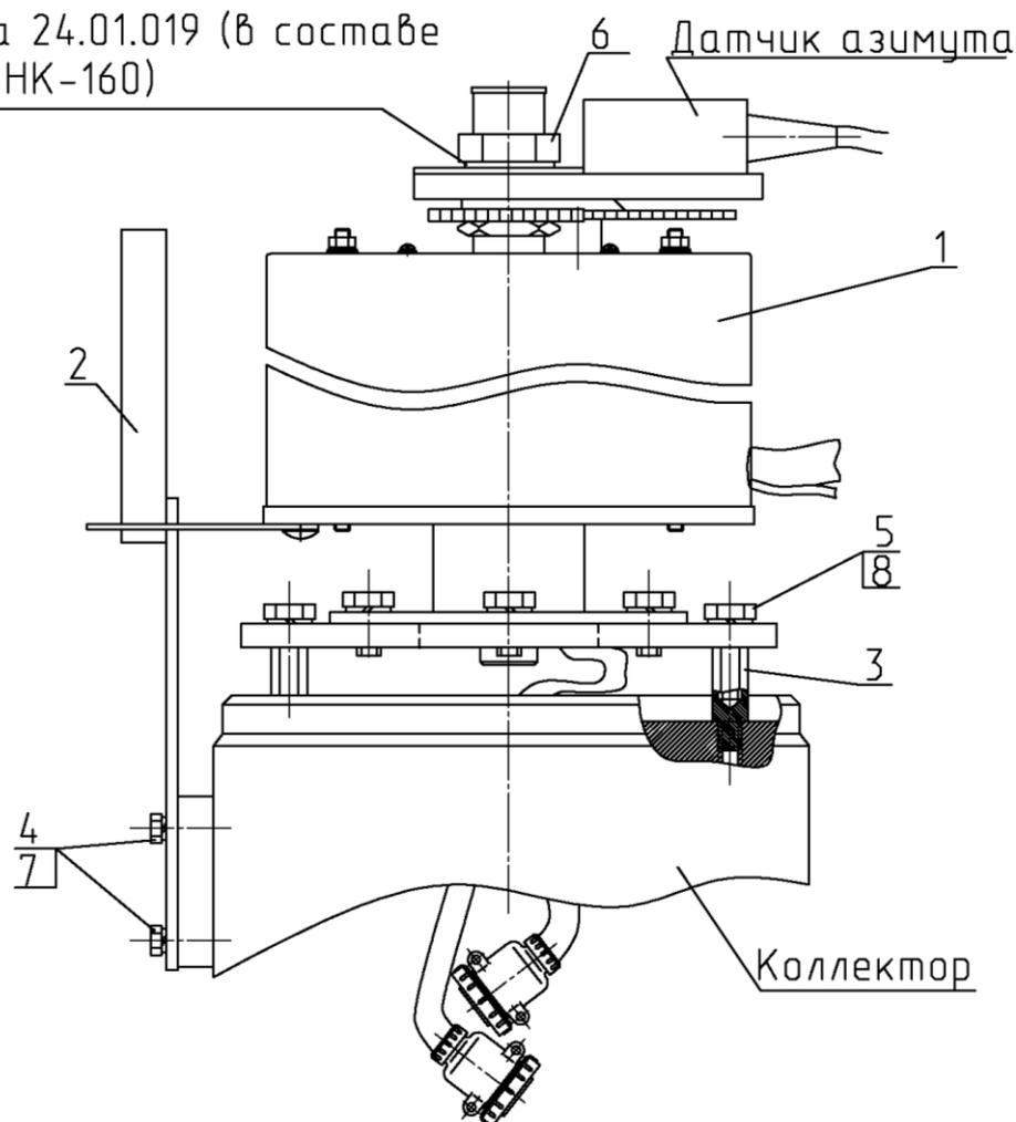
1 – токосъёмник; 2 – кронштейн; 3 – скоба; 4, 5 – болт; 6- гайка; 7,8 – шайба.
