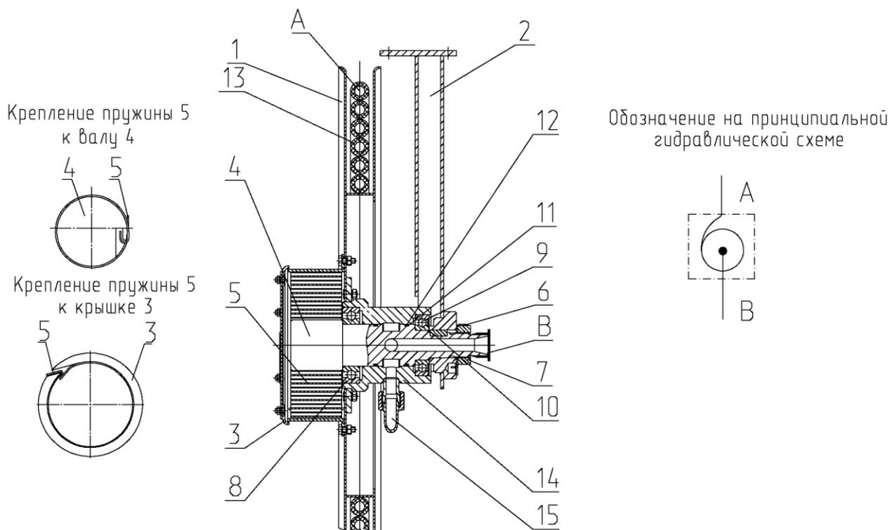
1- барабан; 2- кронштейн; 3- крышка; 4- вал; 5- пружина; 6- шайба стопорная; 7- гайка; 8,9- подшипник; 10- шпонка; 11- кольцо защитное; 12- кольцо; 13- РВД; 14- ступица барабана; 15- трубка.
