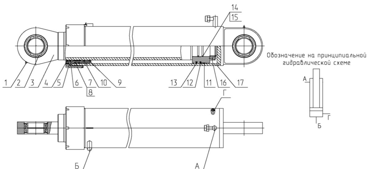
1 – масленка; 2 – подшипник; 3 – шток; 4 - грязесъемник; 6 – штоковое уплотнение; 7 – кольцо защитное; 8 – кольцо; 9 – штоковое опорно - направляющее кольцо; 10 – букса; 11 - поршневое опорно – направляющее кольцо; 12,13 – поршневое уплотнение; 14 – кольцо защитное; 15 – кольцо; 16 – гайка; 17 – гильза.
