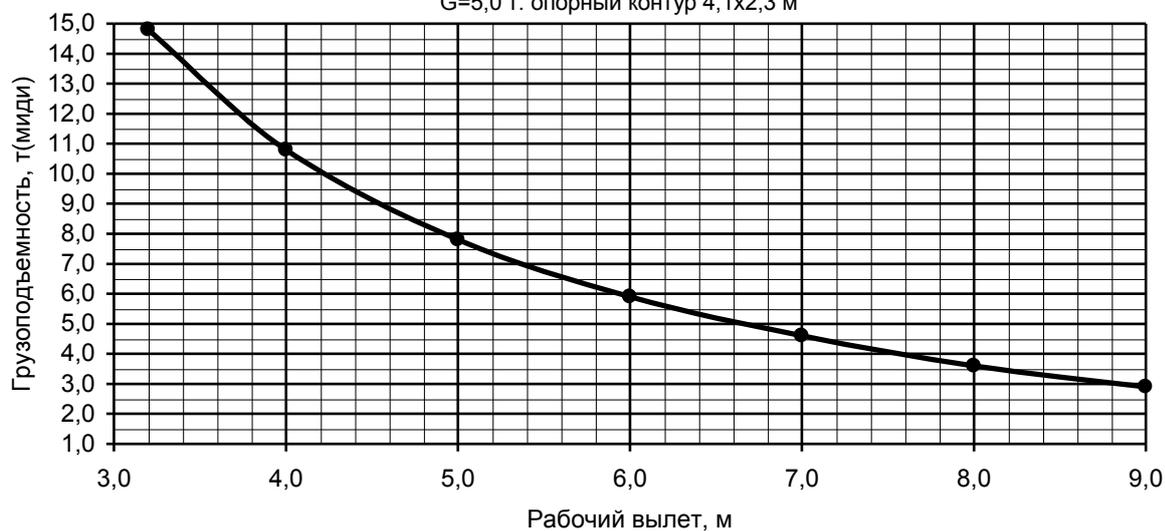
Грузовая характеристика. Лст=12,0м. к=10, зона работы 240 град. и 360 град. , противовес G=5,0 т. опорный контур 4,1x2,3 м
