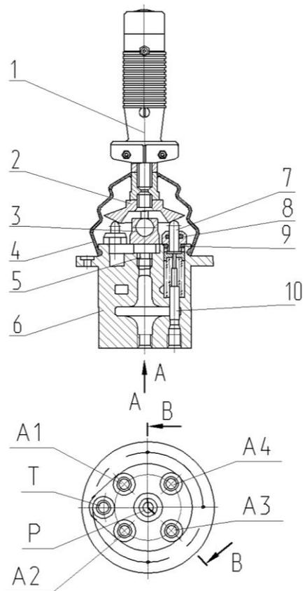
1 – рычаг; 2 – тарелка; 3 – шаровой шарнир; 4 – чехол; 5,9 – уплотнительные кольца; 6,12 – корпус блока; 7 – толкатель; 8 – манжета; 10 – золотник.
