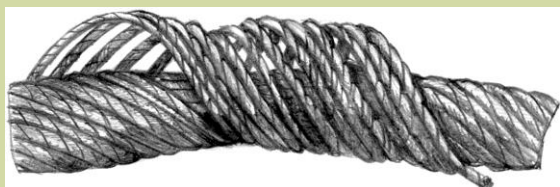
Корзинообразная деформация каната
