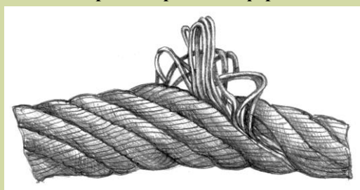
Корзинообразная деформация каната
