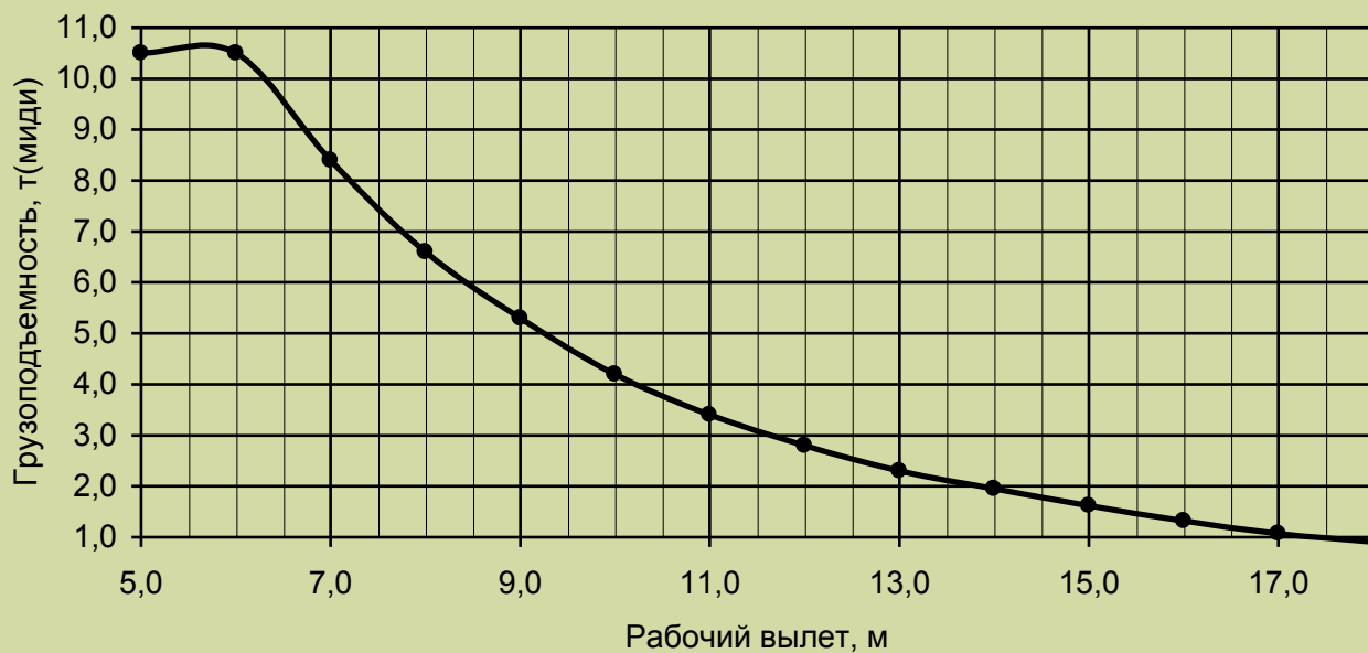
Грузовая характеристика. Лст=18,0-20,0м. \kappa=4 , противовес G=1,7 т.
