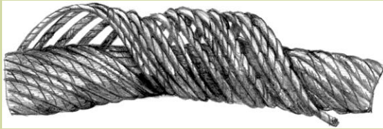
Корзинообразная деформация каната
