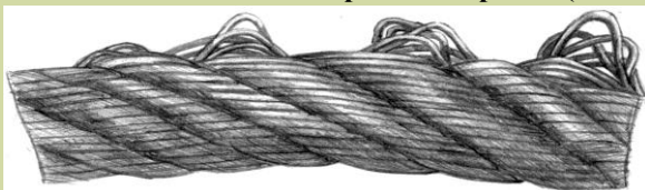
Выдавливание проволок прядей (одной)
