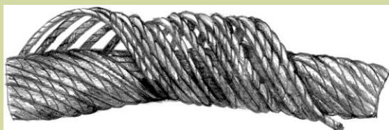
Корзинообразная деформация каната
