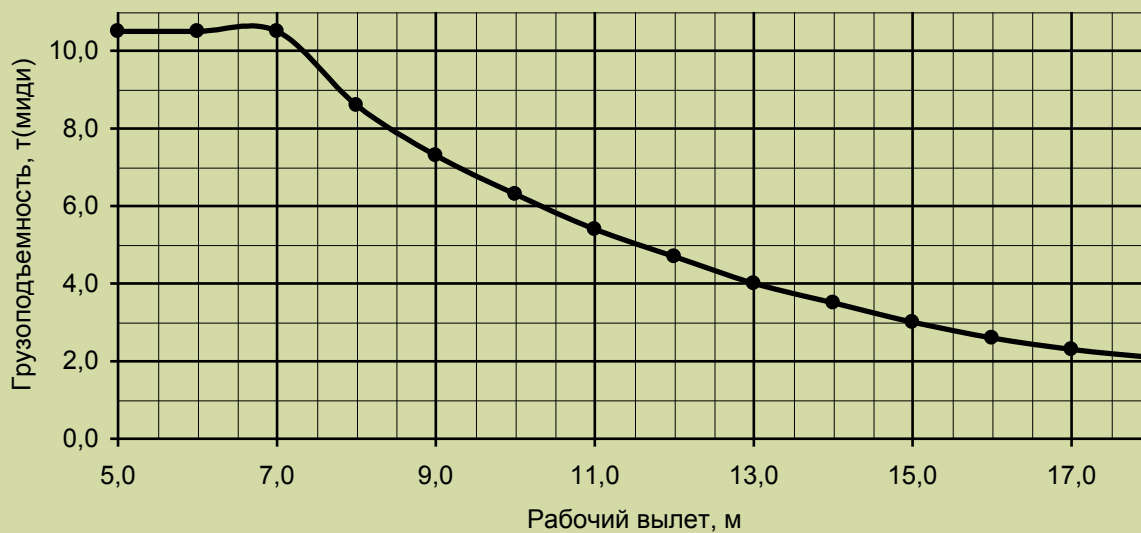
Грузовая характеристика. Лст=20,0-22,0м. \kappa=4 , противовес G=4,2 т.
