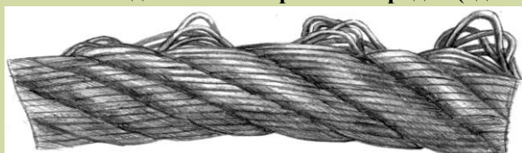
Выдавливание проволок прядей (одной)
