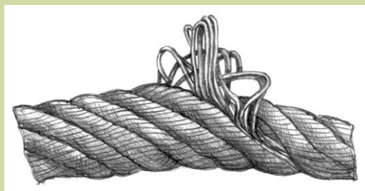
Корзинообразная деформация каната
