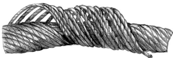
Корзинообразная деформация каната
