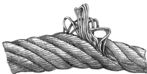
Корзинообразная деформация каната
