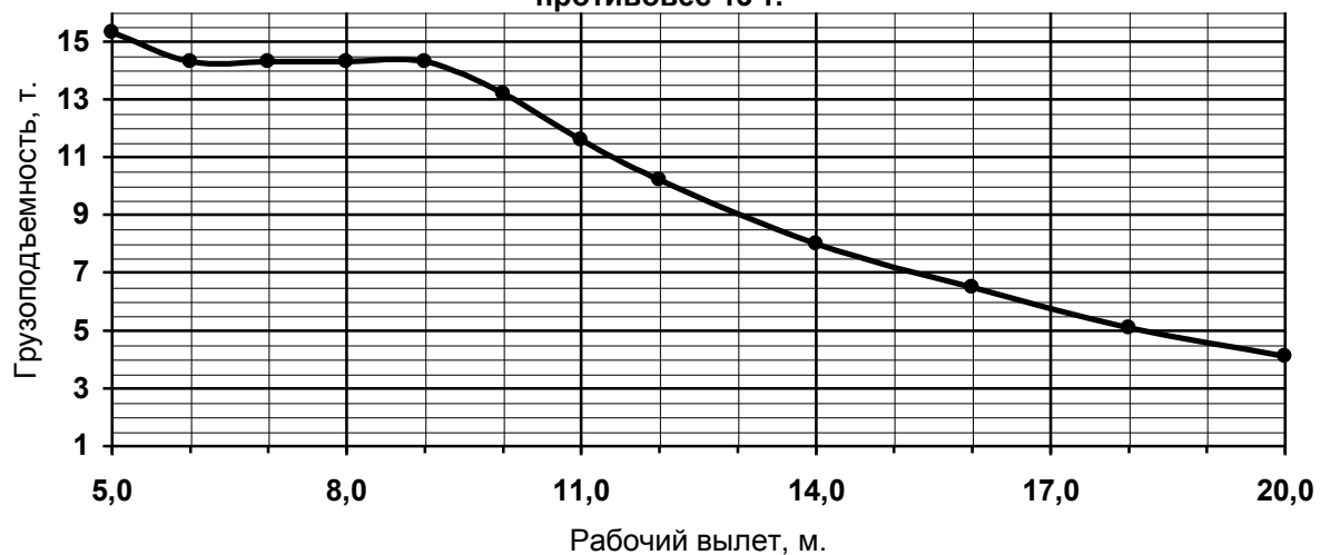
Лст=18,6-22,0м., кратность запасовки k=4 противовес 13 т.
