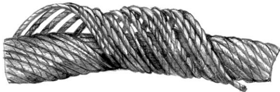
Корзинообразная деформация каната
