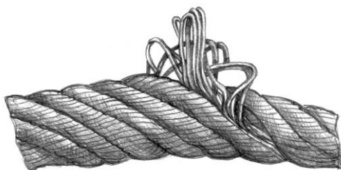
Корзинообразная деформация каната
