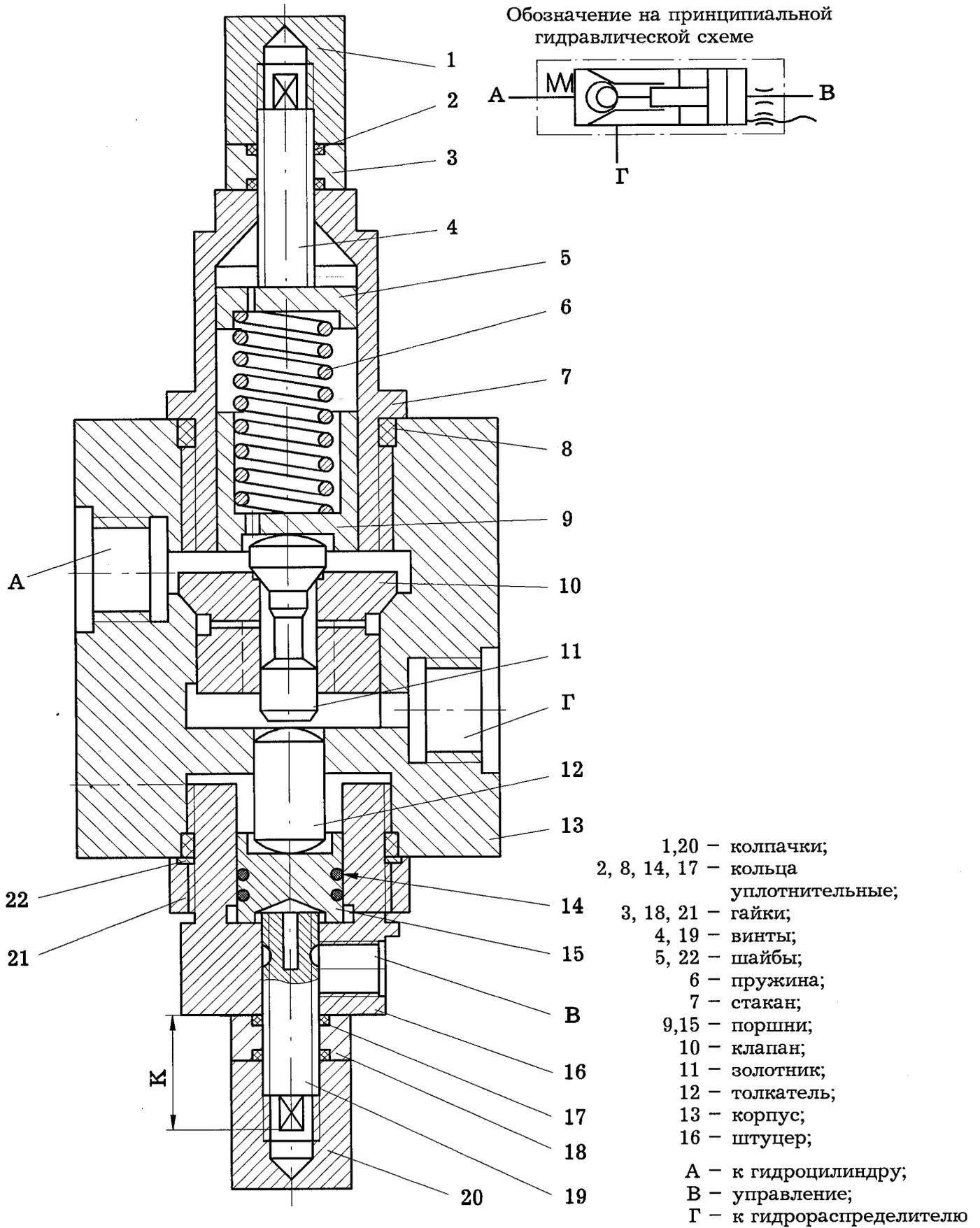
Рисунок 45 - Клапан обратный управляемый
