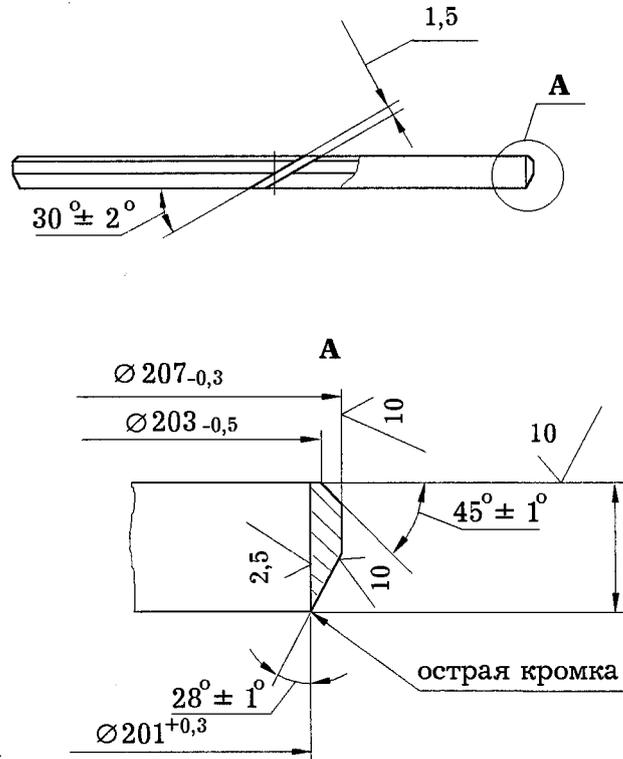
Схема установки демонтажного кольца
