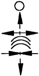
Включение и выключение блокировки рессор
