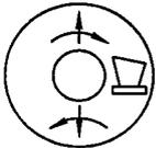
Поворот поворотной платформы и включение звукового сигнала
