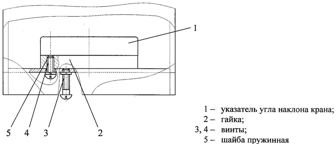
**Рисунок 57 – Установка указателя угла наклона крана**
