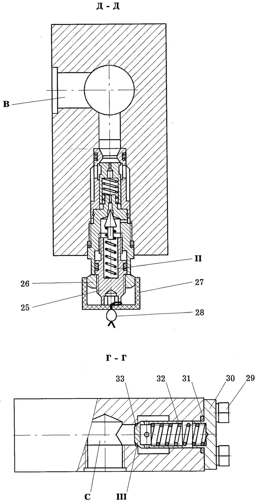
**Рисунок 47.2 - Гидроблок уравновешивания**
