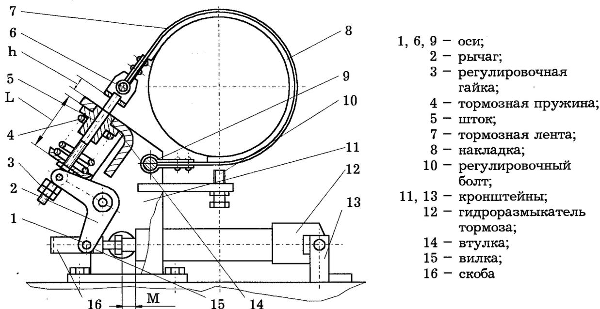
Рисунок 21 - Тормоз ленточный
