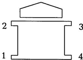
Схема расположения выносных опор на кране
