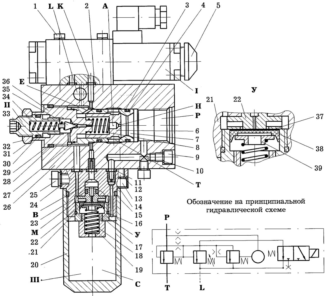
Обозначение на принципиальной гидравлической схеме
