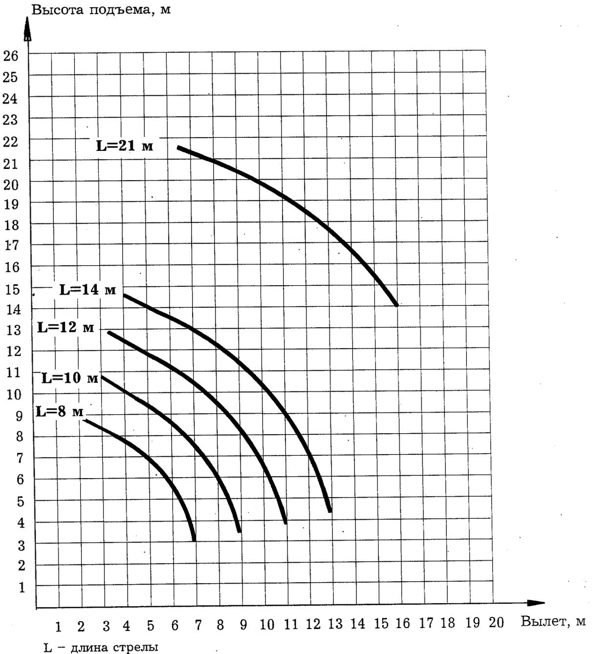
**Рисунок Б.1 - Высотные характеристики**
