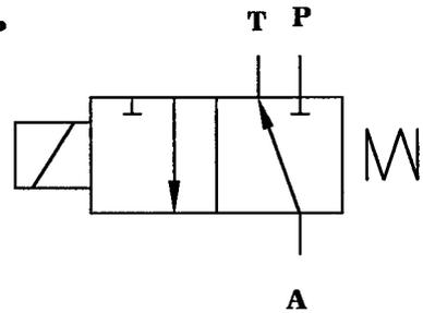
**Рисунок 37 - Гидрораспределитель с электрическим управлением**
